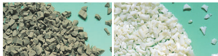
TPE (エラストマー) TPE (Thermoplastic elastomer) PUR (ウレタン) PUR (Polyurethane)
