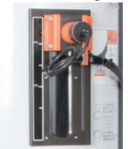
材料レベルセンサが移動でき、仕込み量を調整することができます。
